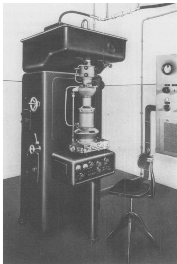
Abb. 11. Erstes von Siemens serienmäßig hergestelltes Elektronenmikroskop (Ansicht) [21].
